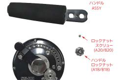
ゆるみ止めのロックナットスクリューを外します。 次にハンドルロックナットをモンキーレンチ等の 工具でゆるめて外します。
