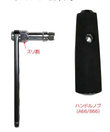
ハンドルノブ軸のスリ割部をモンキーレンチ等の工具で固定した 状態でハンドルノブを反時計回りにゆるめ外します。
